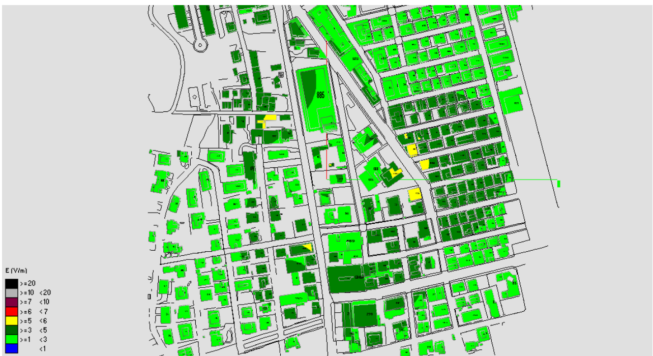
Fig. 8 Impatto elettromagnetico – Zona Via Aleardi – Vista dall'alto
