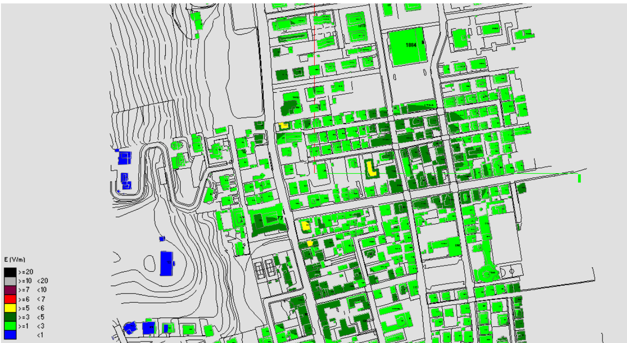
Fig. 139 Impatto elettromagnetico – Zona Via Tevere – Vista dall'alto
