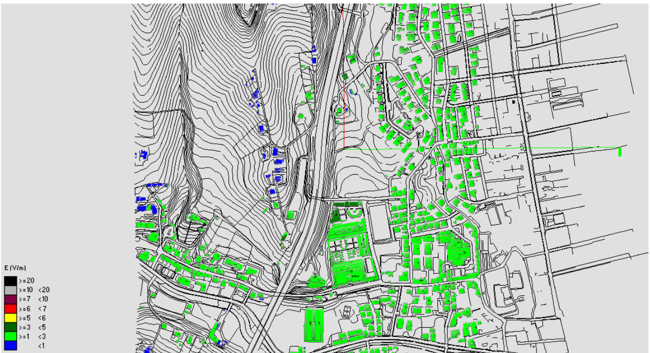
Fig. 13 Impatto elettromagnetico – Zona Area Cimitero e Autostrada – Vista dall'alto
