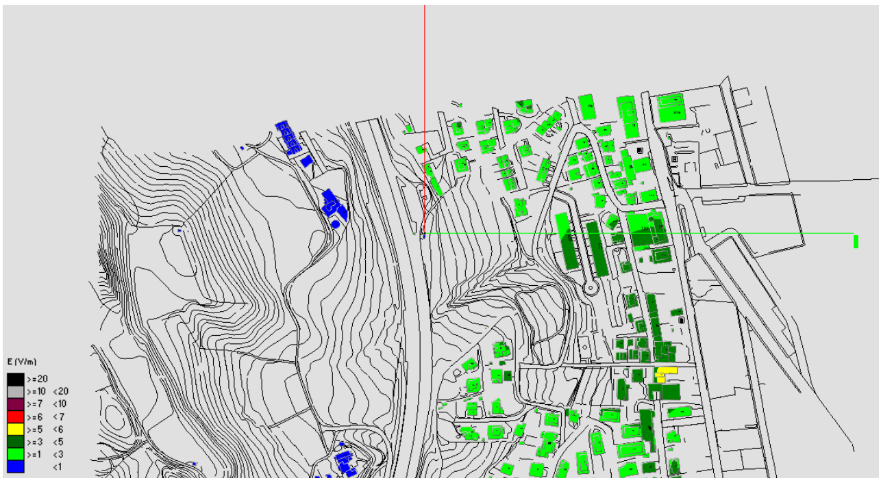
Fig. 3 Impatto elettromagnetico – Zona A14 Km 303+800 – Vista dall'alto
