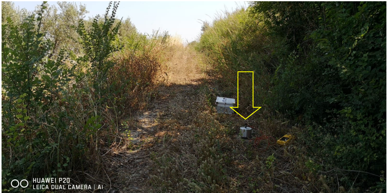
Figura 1 - Ubicazione del sensore di superficie 3D-2Hz per la misura di microtremori a stazione singola HVSR.
