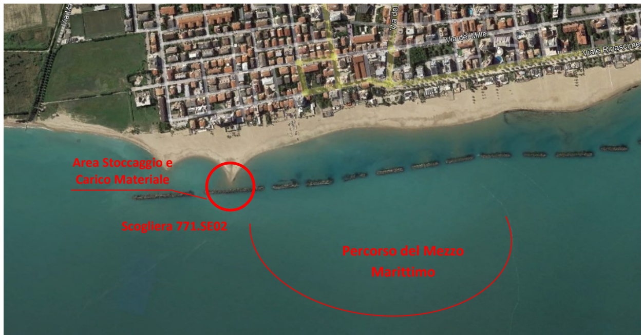
Figura 6.2 – Planimetria con indicazione delle zone di carico del materiale e del percorso del mezzo marittimo OPZIONE 2
