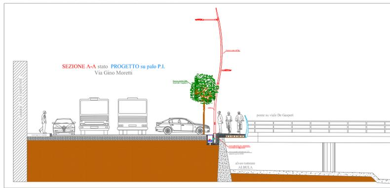
SEZIONE A - A stato di progetto scala 1:100
