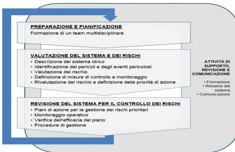
Figura 2. Rappresentazione schematica delle fasi di un PSA
